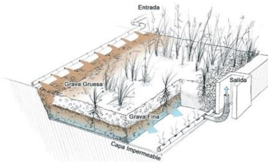
Figura 37. ESQUEMA DE FUNCIONAMIENTO DE UN HUMEDAL ARTIFICIAL
