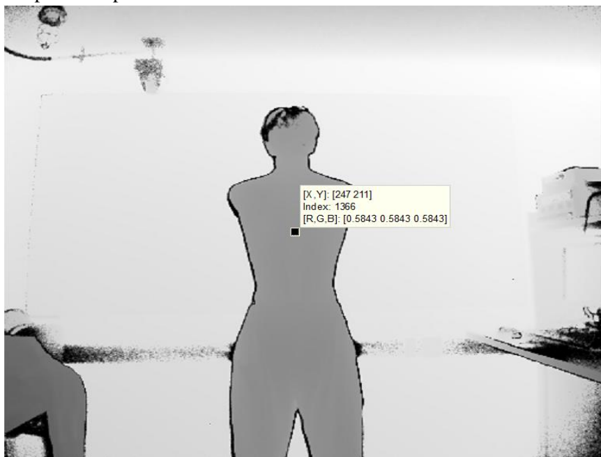
Figura 6 Imagen de profundidad donde se indica el valor en distancia de un píxel en mm
