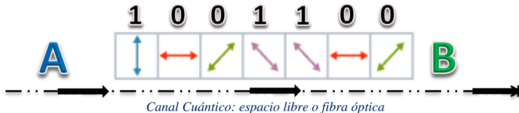
Figura 14. Transmisión de cadena de fotones de polarización aleatoria de A a B.
