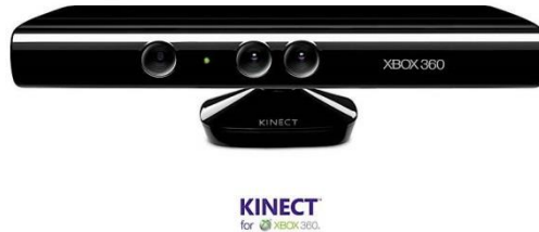
Figura 2.1.1.1. Sensor visual RGB-D Kinect [5].
