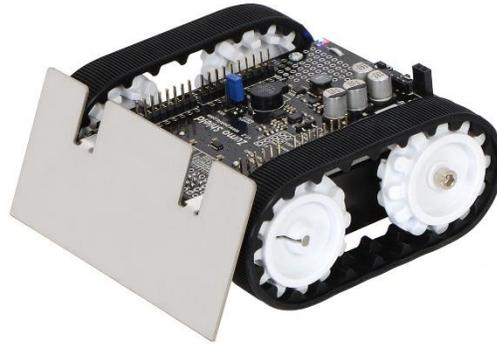
**Ilustración 28.** Chasis con llantas tipo oruga y sensores de reflexión.
