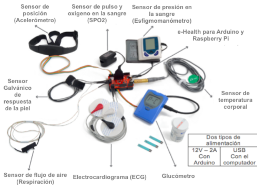
Figura 2-1.: Esquema traducido de aplicaciones médicas que puede monitorear e-HSS. Basado en [19]
