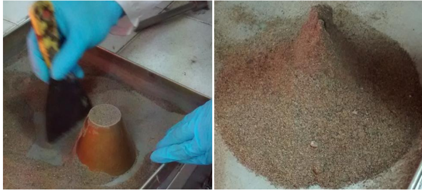
Figura 25- Prueba del cono para condición del suelo saturado superficialmente seco
