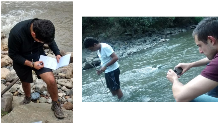
Figura 15 - Toma de velocidades mediante el uso del micro molinete de cazuelas
