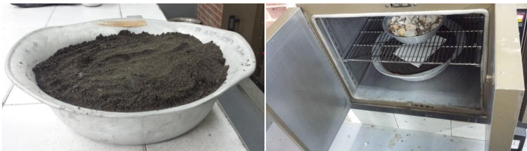
Figura 21- Proceso de secado, muestra de suelo Río Sunuba
