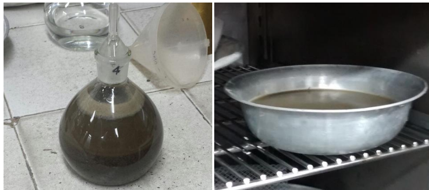
Figura 26- Picnómetro N°4, material sumergido, proceso de secado del suelo fino
