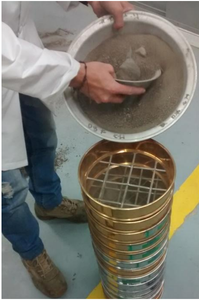
Figura 22- Proceso de tamizaje de material del lecho del Río Sunuba
