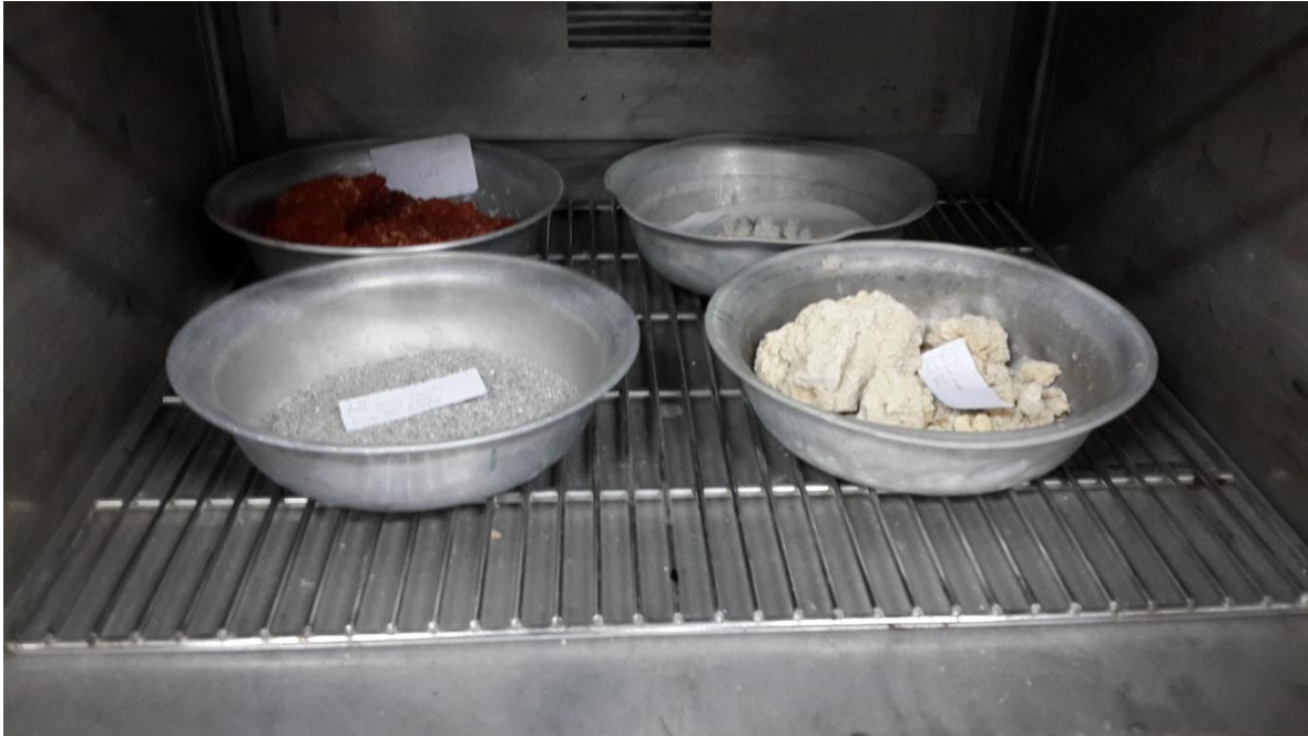
Fotografía 6. IGMS, Muestra Roja, Arena de Ottawa, Arena de Guamo, Muestra Blanca, en el horno convencional a 110° C.
