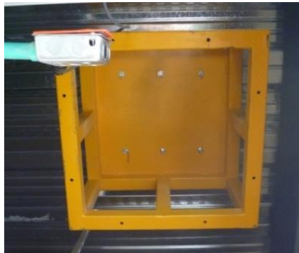
Figura 120 .Placa metálica para Acelerómetro (Fuente: Tomado por el Ing. Daniel Ruiz Valencia)
