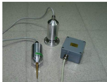
Figura 193. Acelerómetro de 3 componentes MTSS-1033A/1043A (Fuente: Tomada Anexo 1 cotización R-sensors)
