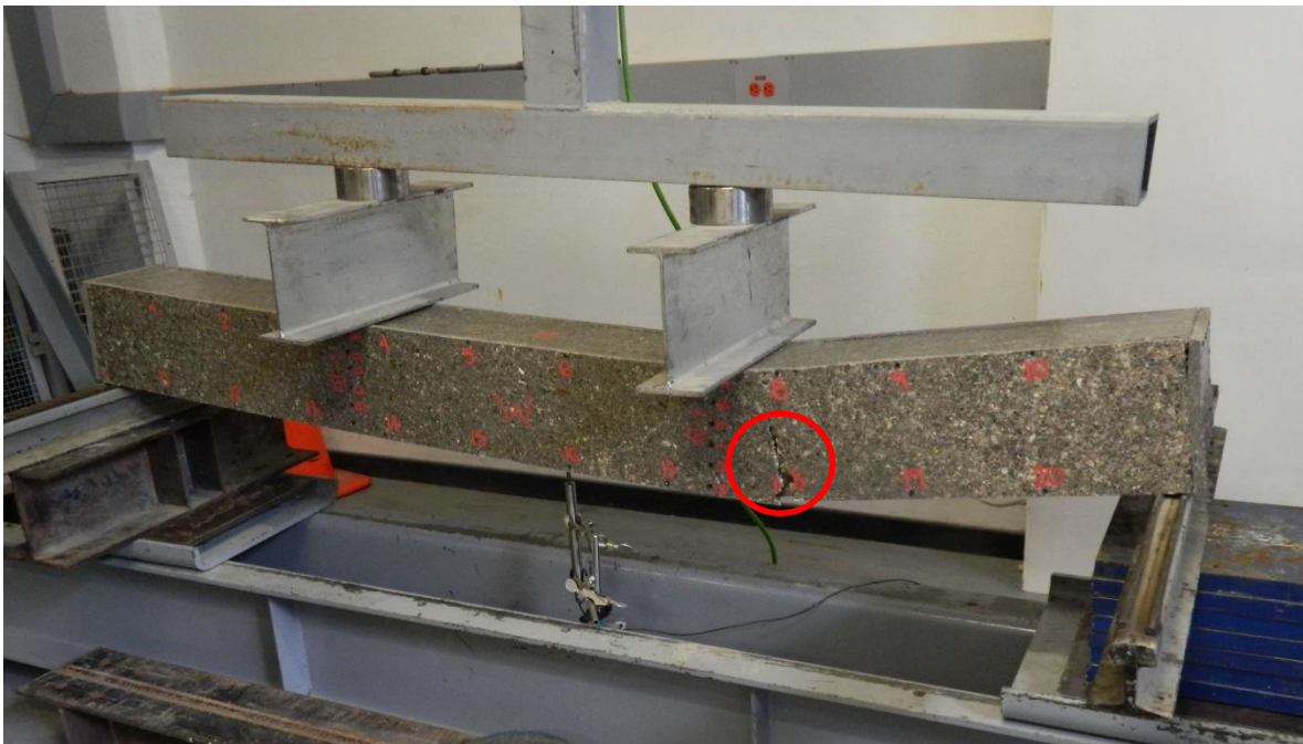
Figura 62. Falla de la viga por cortante
