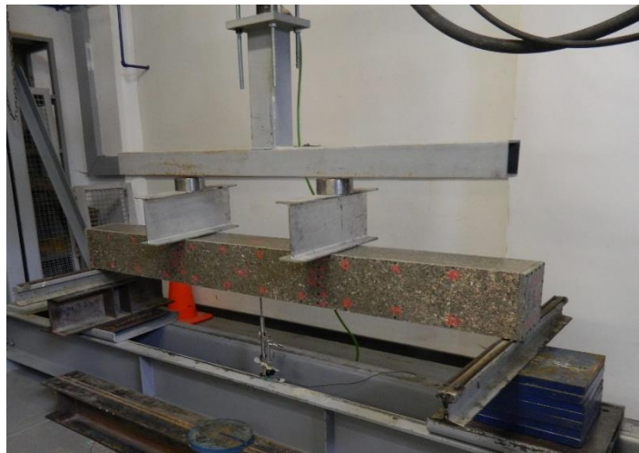
Figura 57. Montaje de viga simplemente apoyada
