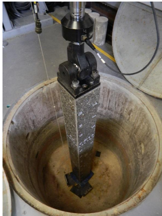
Figura 58. Montaje de columna con apoyos de rótula
