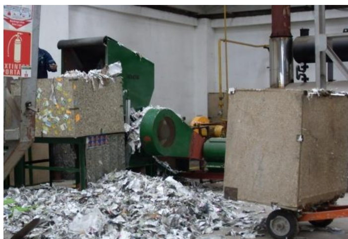
Figura 6. Molino triturador Tomado de Becerra y Villabona, (2009).
