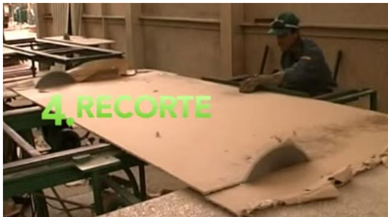
Figura 8. Mesa de recorte Tomado de: Tetra Pak, (2009).
