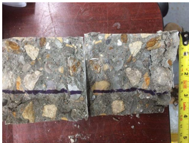
Ilustración 11. Penetración espécimen con 0% de AET.
