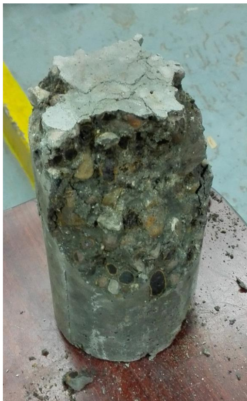
Ilustración 10. Falla de la mezcla con 100% de reemplazo de AET sometida al ensayo de resistencia a compresión.
