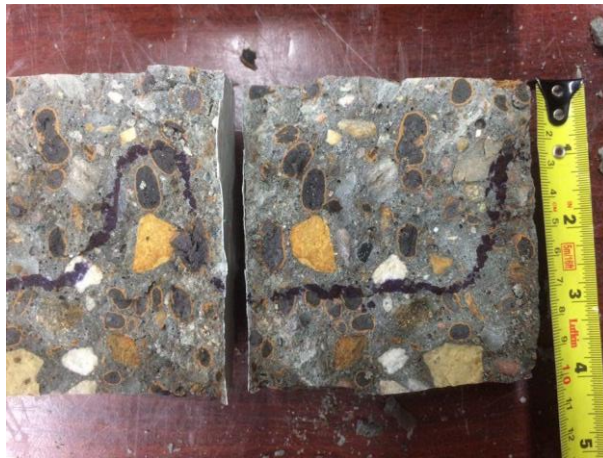
Ilustración 12. Penetración espécimen con 25% de AET.
