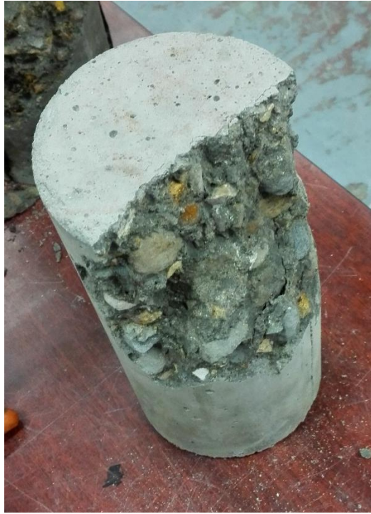
Ilustración 7. Falla de la mezcla testigo sometida al ensayo de resistencia a compresión.
