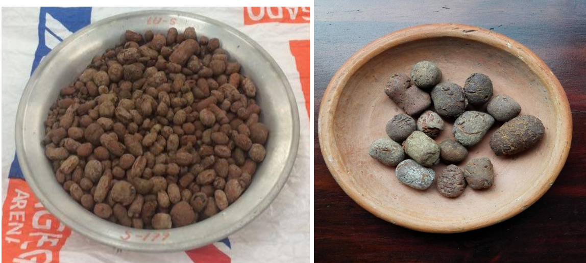
Ilustración 1. Arcilla expandida térmicamente elaborada por Corona en el valle del Aburra
