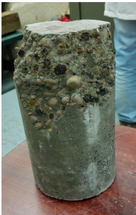
Ilustración 9. Falla de la mezcla con 50% de reemplazo de AET sometida al ensayo de resistencia a compresión.
