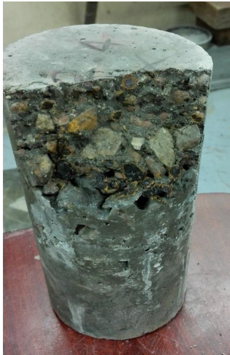
Ilustración 7. Falla de la mezcla testigo sometida al ensayo de resistencia a compresión.
