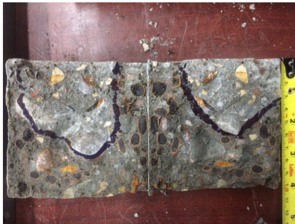
Ilustración 13. Penetración espécimen con 50% de AET.
