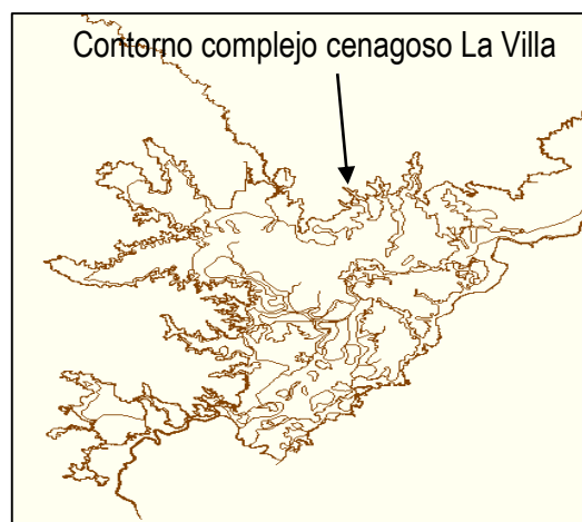
Figura 23. Geometría de entrada del modelo Delft 3D.
