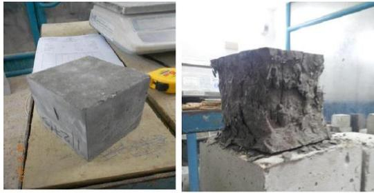
*Figura 8. Ensayos de resistencia a la compresión cubos de UHPC
