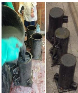
Figura 58. Fabricación de testigos para cada viga.
