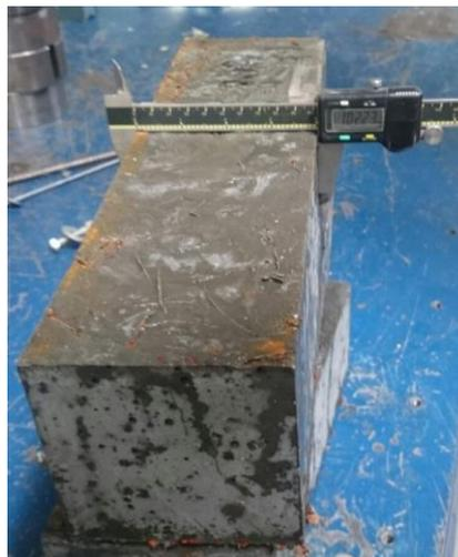
*Figura 44. Medición de los especímenes preliminares de acuerdo a la norma INV E 414-2013.*
