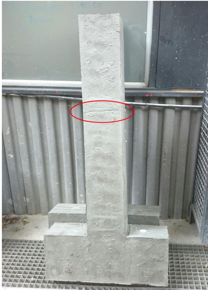
*Figura 93. Fisuración por retracción y asentamiento plástico en viga de UHPC. .*
