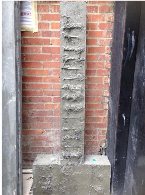
*Figura 81. Viga UHPC al 3% de dosificación de fibras metálicas.*
