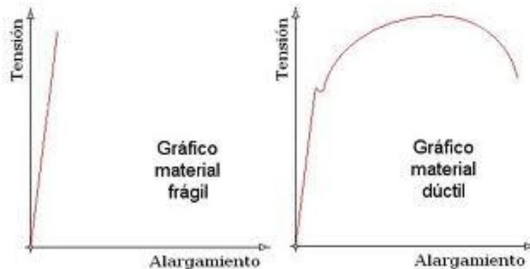
Figura 4. Comportamiento de un material dúctil vs un material frágil.
