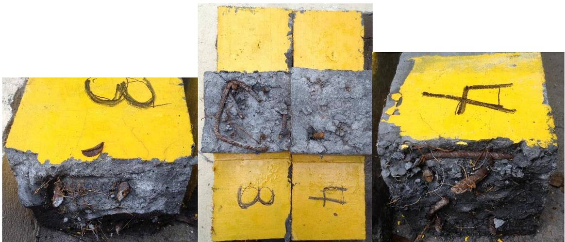
Figura 95. Falla de las vigas de 1.5%.
