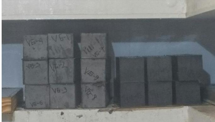
*Figura 43. Muestras de especímenes preliminares en el cuarto de curado.*
