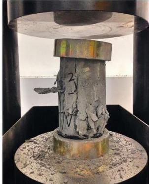
*Figura 59. Ensayo de resistencia a la compresión.*
