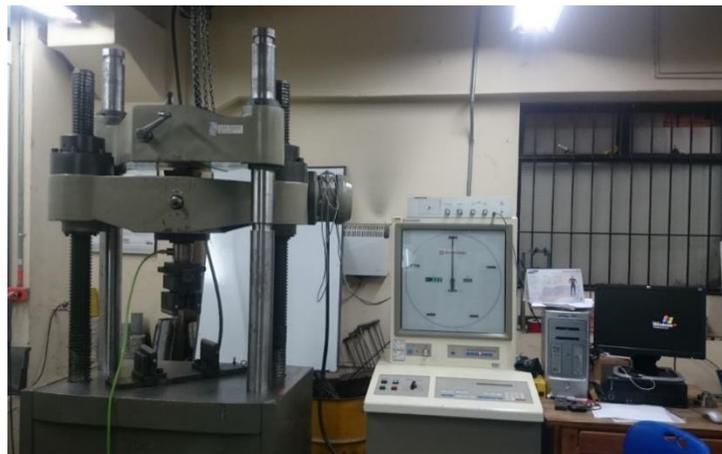
*Figura 45. Instrumentación para ensayos de resistencia flexural de acuerdo a la norma INV E 414-2013.*
