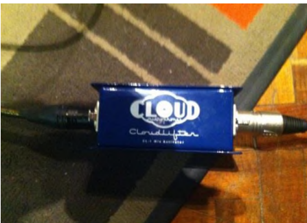
Imagen 3. Cloudifter CL-1 Mic Activator
