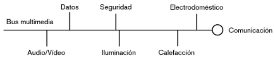
Figura 1.1. Definición teórica de Domótica mediante la disponibilidad de un bus doméstico multimedia.
