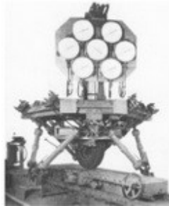
Fig. 5 Primer prototipo robot paralelo ideado por V.E. Gough
