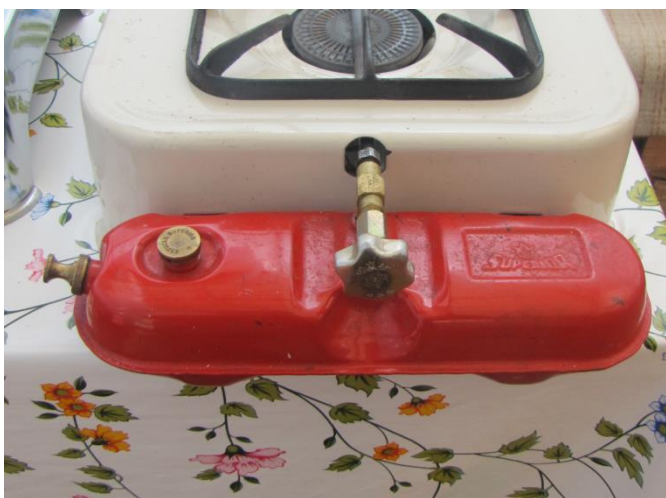
Ilustración 19. Detalle del tanque una estufa a gasolina se observa la llave, en donde se encuentra la aguja, y lleva la gasolina a los fogones. También se detalla al lado izquierdo el dispositivo por el cual se le bombea manualmente, y que ocasiona la mayoría de los accidentes. Esta estufa se encontraba guardada y empolvada en la casa de Araminta que hoy día utiliza gas natural.
