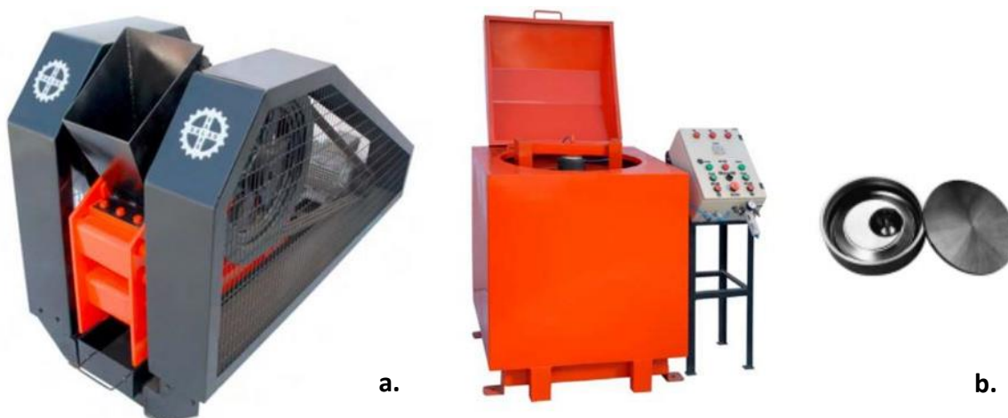
Figura 2. Equipos utilizados para la primera etapa de preparación de las muestras, pertenecientes a la Universidad Andrés Bello. Imágenes de catálogo, Ingeniería y Construcciones Salas Hermanos Ltda. a) Trituradora de mandíbula, laboratorio de chancado. b) Pulverizador, laboratorio de pulverizado.
