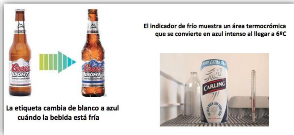
Figura 8: Tinta termocrómica en etiqueta de cervezas (CITA-CTIC, Laura Guttierrez).
