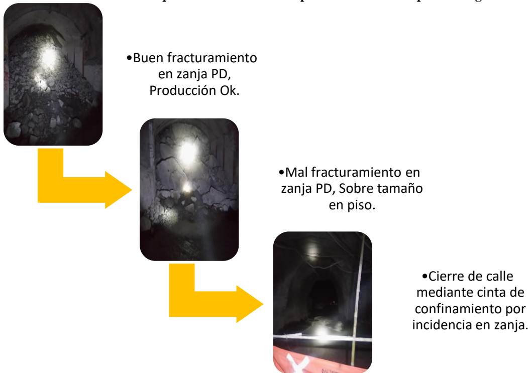
Ilustración 8. Esquema de cierre de calle por acumulación de puntos colgados.
