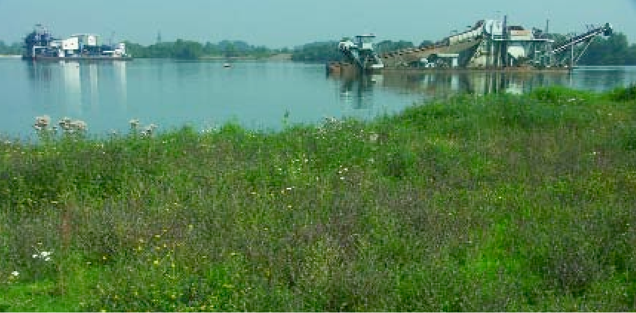
8.1 • 'Natte' grindwinning in een diepe grindplas langs de Maas (foto Bart Peters).
