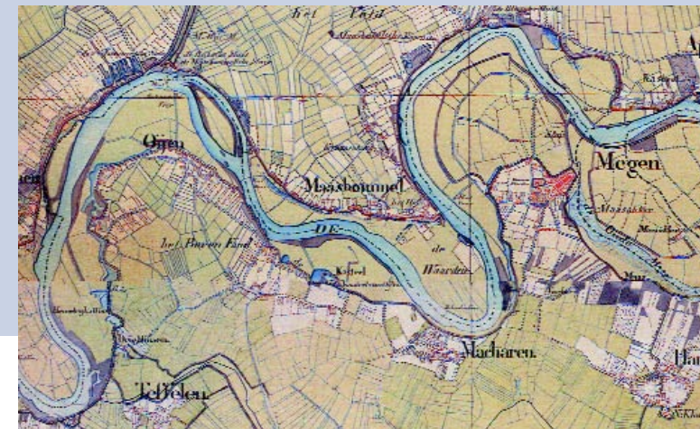
2.13 • Drie trajecten van de Maas rond 1840. Deze drie trajecten vertonen duidelijke verschillen als gevolg van de geologie. Linksboven de vroegere Maasloop in het huidige Maasplassengebied bij Linne. Hier zijn nog enkele eilanden en semi-actieve point bars (grindbanken in de binnenbocht) zichtbaar. In dit gebied wordt de rivierloop steeds flauwer en neemt de stroomsnelheid af. Veel grind dat uit de Grensmaas is meegevoerd, blijft hier in gevarieerde patronen liggen. Het voormalige eiland 'Den Hollander' is als schiereiland al deels in cultuur gebracht. Door normalisatiewerkzaamheden na 1840 is het afsnijden van de grote meander ('de Lus van Linne') op het nippertje voorkomen. Rechtsboven de Maas in Noord-Limburg bij Venlo. De rivier snijdt zich hier in in de Peelhorst, die omhoog komt. De rivierloop is daardoor vrij recht en er zijn weinig
