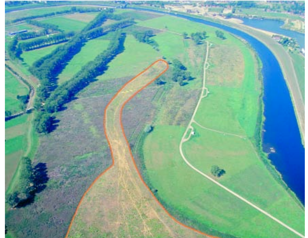
5.15 • Luchtfoto van de hoogwatergeul (oranje contouren) in natuur- en waterwingebied De Rug bij Roosteren langs de Grensmaas in 2002. De geul werd in 1996 gegraven om klei te winnen voor de aanleg van de kades rond Roosteren (foto Jan van de Kam).
