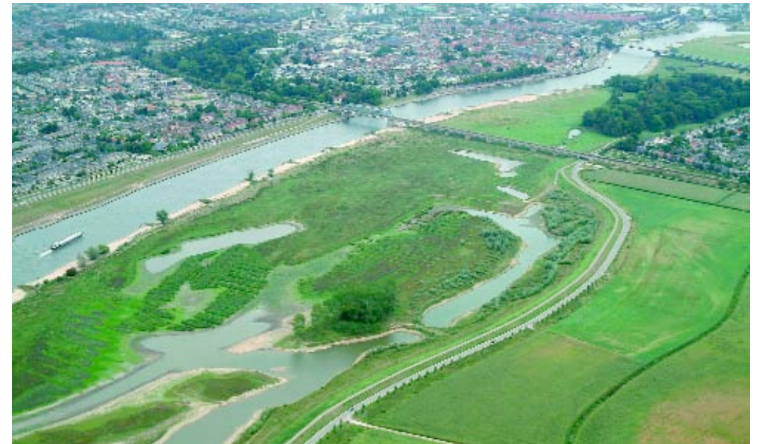
5.6 • De Ossenwaard bij Deventer langs de IJssel. Hier zijn nieuwe geulen gegraven en gekoppeld aan bestaande strangen (foto Rijkswaterstaat).
