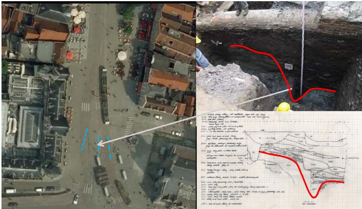
afb. 19: Doorsnede van één van de afwateringsgrachten (Stad Gent, Dienst Stadsarcheologie)
