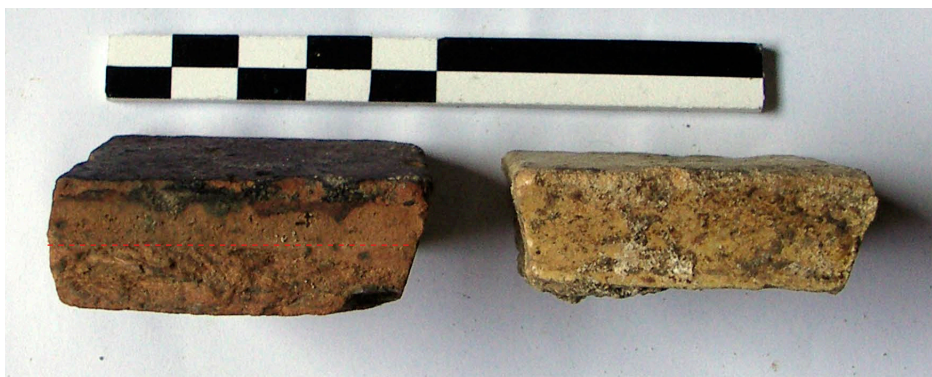
De kleine tegeltjes zijn afkomstig van grotere splijttegels. Bij de rode tegel zijn de nerf die als splijtrichting diende en het breukvlak goed waarneembaar. De rechter tegel toont dit breukvlak niet.
