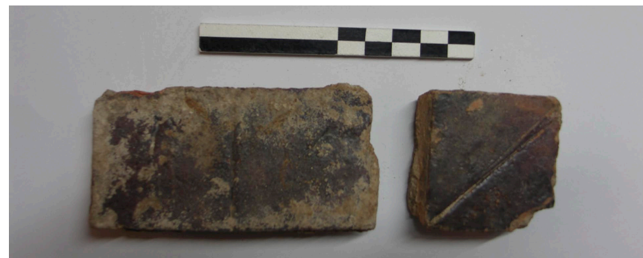
Gele tegel waarbij de diepte van de nerf (aanwezigheid van glazuur) en het breukvlak goed zichtbaar is.
