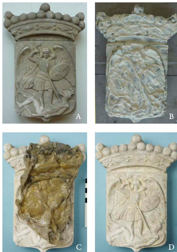
FIG. 42 Schildje met voorstelling van Sint-Michiel: vóór (A), tijdens (B-C) en na reiniging (D), met de reinigingspasta Dust-Away van Superlook (foto's E. Jacobs en H. Denis)
