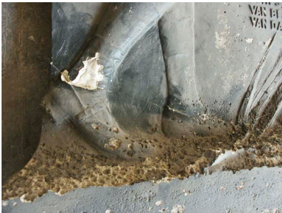
FIG. 7 Erosie van gips in buitenopstelling, ondanks de beschermende verflaag (foto P. Schurmans)
