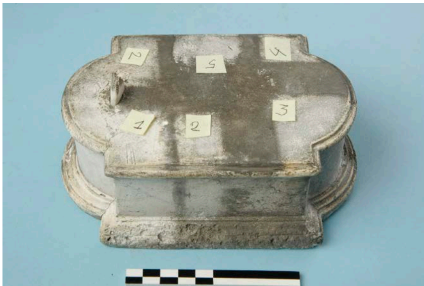
FIG. 41 Reinigingsproeven op een gips zonder afwerkingslaag (foto H. Denis)
