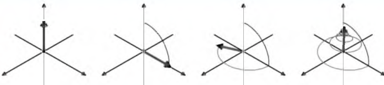
Figuur 5: Een korte radiopuls brengt de magnetisatie loodrecht t.o.v. het externe magneetveld. Vervolgens beweegt deze in een spiraliserende beweging terug naar de evenwichtpositie parallel aan het externe magneetveld.
