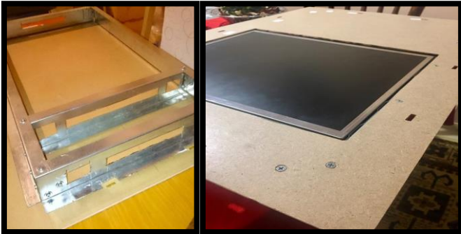
2.ábra Smart Mirror váz & szerelt LCD monitor
