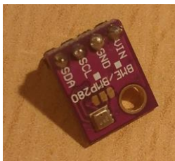
3. ábra: A GY-BME280 kombinált szenzor
