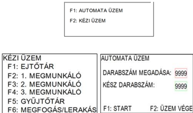
12. ábra: HMI-re általam készített felületek
