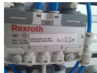
6. ábra: Elektromos működtetésű, 5/2-es, rugó visszatérítéses pneumatikus útváltószelep
