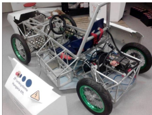
2. ábra: Az autó jelenlegi állapota, burkolat és akkumulátor nélkül
