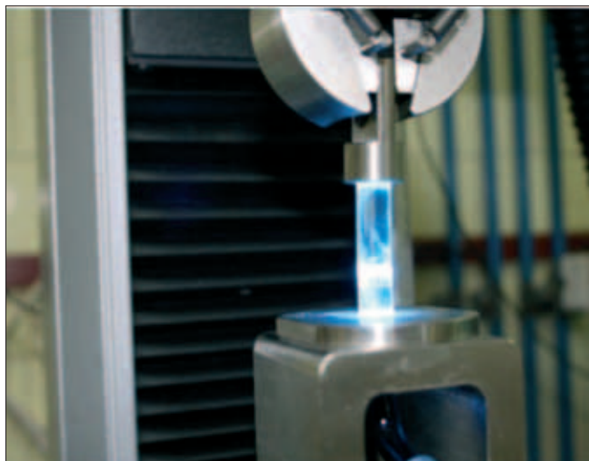
1. ábra. A polimerizációs zsugorodást mérő műszer központi része mérés közben.
