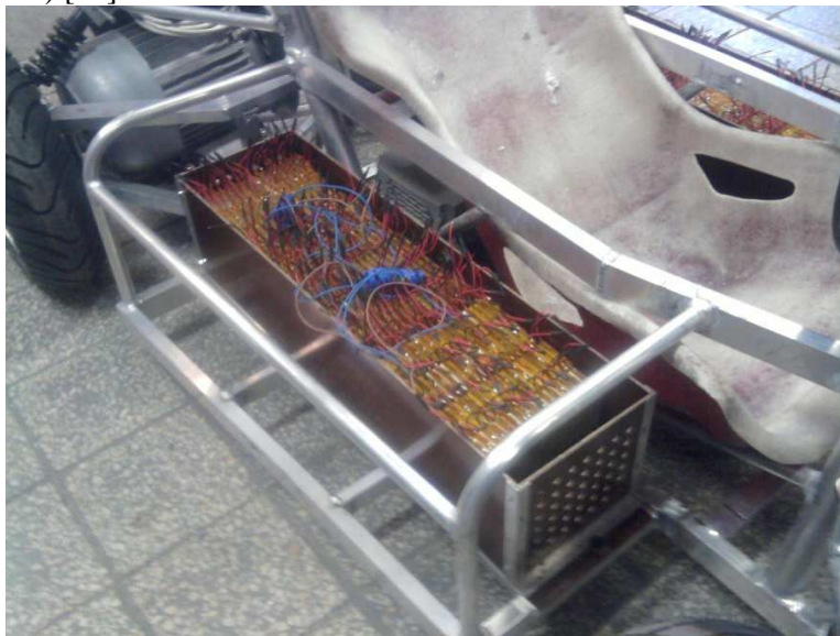
7. ábra A versenyautó váza és az akkumulátorok [13]
