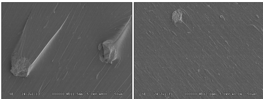
3. ábra: SEM felvétel az Eb ® 80 (bal oldalon) és a DVE-3 (jobb oldalon) monomerben diszpergált nanorészecskékről
