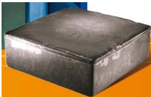
6. ábra Szilícium öntvény a Yingli Green Energy Baodingi (Kína) üzemében. Az üzemben 400 kg tömegű (840*840*240 mm) és 270kg tömegű (690*690*250 mm) polikristályos szilíciumöntvényt gyártanak.
