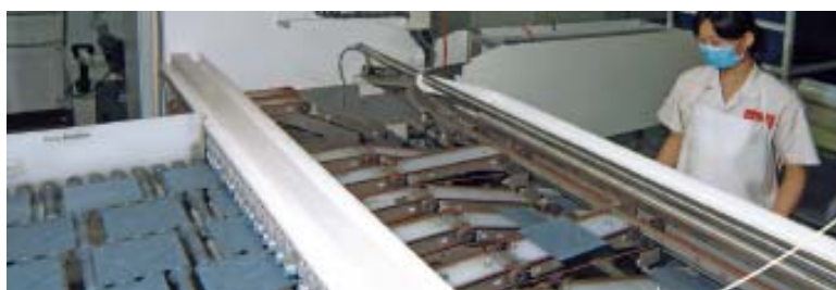
8. ábra Polikristályos lapok előkészítése maratásra a Yingli Green Energy Baodingi (Kína) üzemében.
