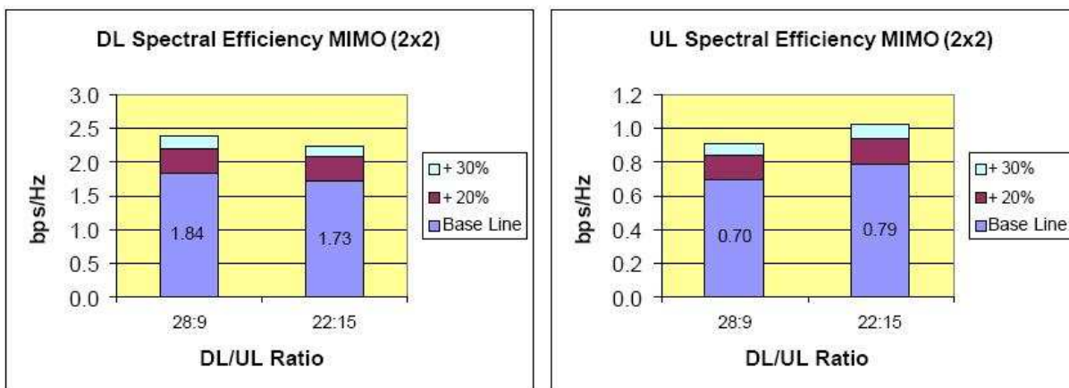
10. ábra: Spektrális hatékonyság javulása optimalizált rendszer esetén
