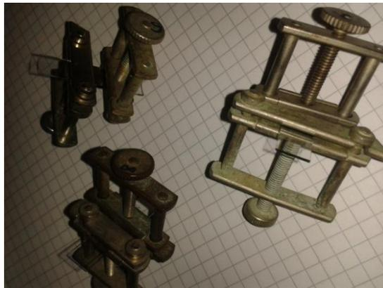
**Abbildung 3.53:** Foto von drei Substraten vor dem Trocknungsvorgang. Zum Anpressen der Glasplatten wurden kleine Schraubzwingen verwendet.
