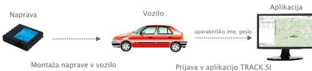
Slika 3.1: Shema delovanja sistema Track.si
