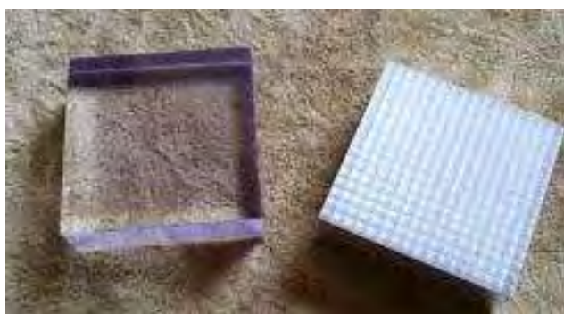
Σχήμα 3.2. Παράδειγμα ομογενή (αριστερά ) και διακριτοποιημένου σπινθηριστή (δεξιά)
