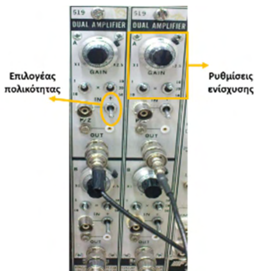
Σχήμα 4.14. Ενισχυτές φασματοσκοπίας και επιλογές ρυθμίσεών τους
