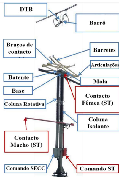
Figura 11 – Exemplo ilustrativo de principais constituintes de um SX com acoplamento de um ST [14]
