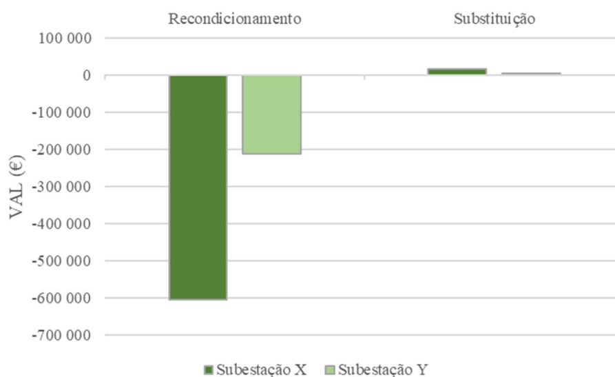
Figura 63 - Cenários comparativos de possíveis intervenções em seccionadores
