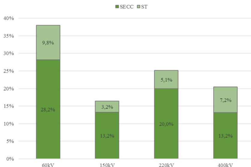
Figura 30 - Distribuição percentual de seccionadores por nível de tensão e tecnologia (SECC: inclui SP, SX, SV, SH)
