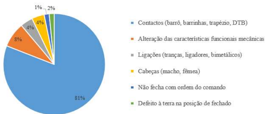
Figura 42 - Distribuição percentual das avarias na componente de ativa
