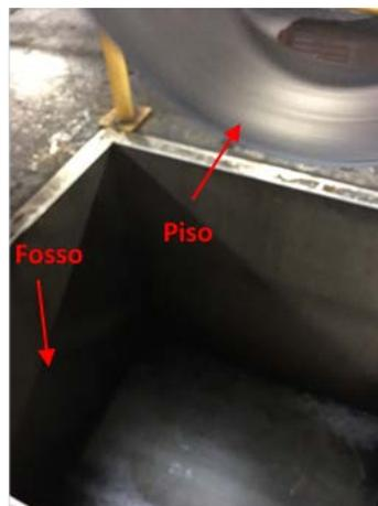
Figura 49 – Fosso da extrusora E04 após o incremento de profundidade (Continental Mabor, 2016).
