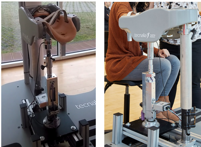
Figura 2: El robot de rehabilitación UHP (Universal Haptic Pantograph) sin y con usuario.
