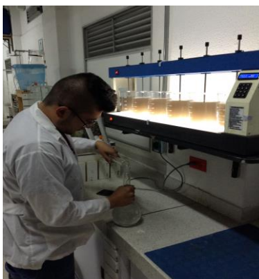
Ilustración 40 Ensayo test de jarras
