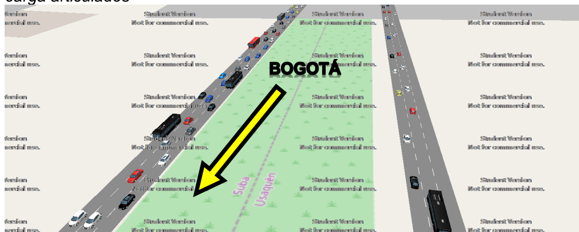
Figura 54 Autopista norte - Modelo PTV Vissim con restricción de vehículos de carga articulados
