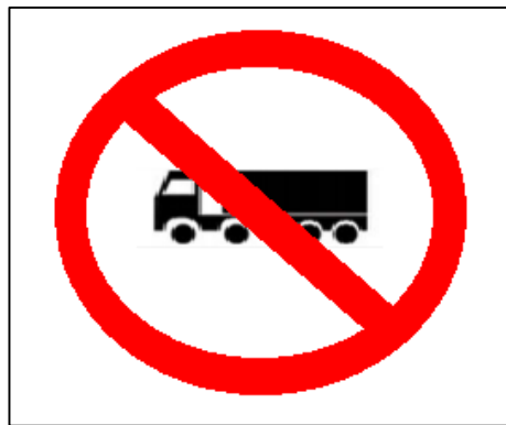
Figura 48 Circulación prohibida para vehículos de carga articulados
