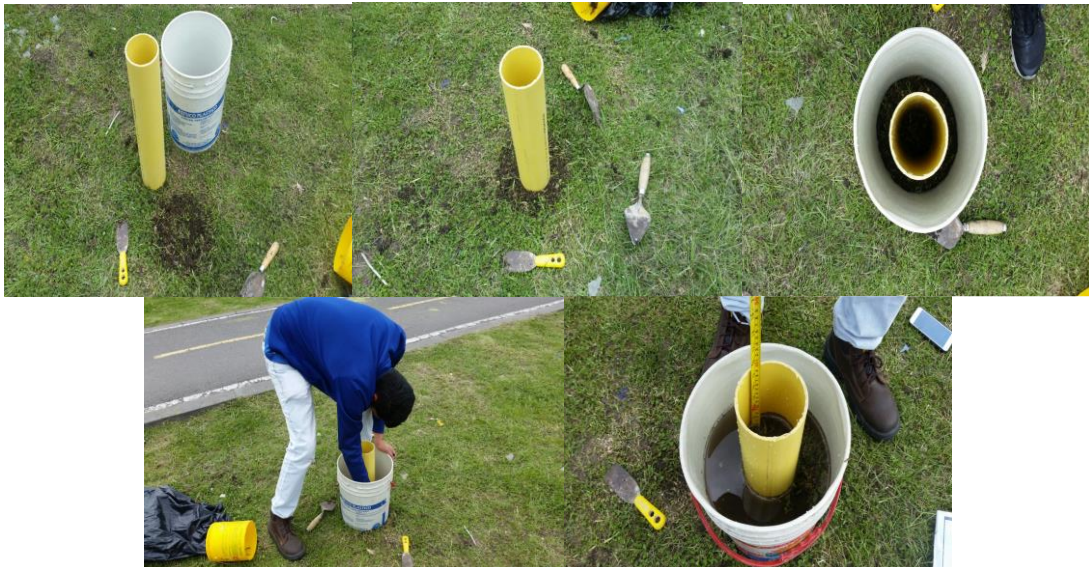
Figura 15. Ensayo en campo con anillos de infiltración
