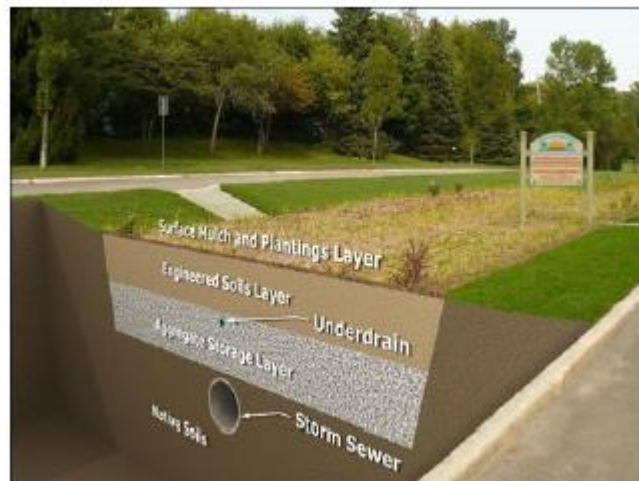
Figura 4. Dren filtrante capas granulares.
