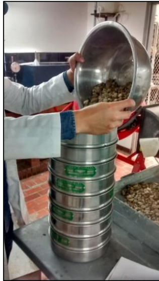
Ilustración 16 Granulometría de agregados gruesos para la mezcla
