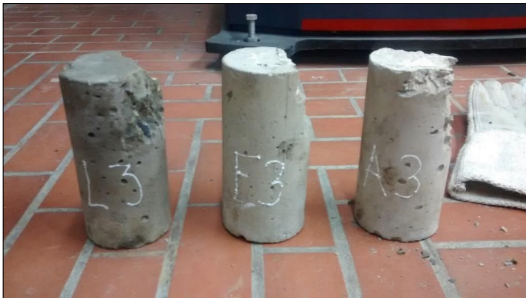
Ilustración 30 Falla a compresión de cilindros 28 días de curado
