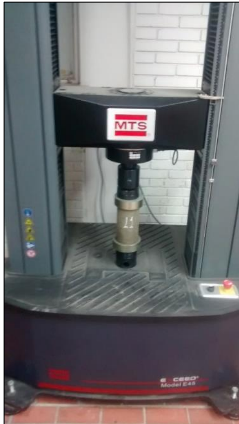
Ilustración 23 Ensayo a compresión de muestras cilíndricas de concreto
