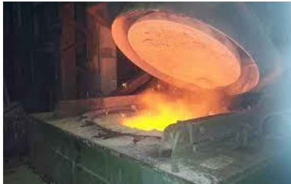
Ilustración 5 Fotografía horno de fundición sobre base en concreto.
