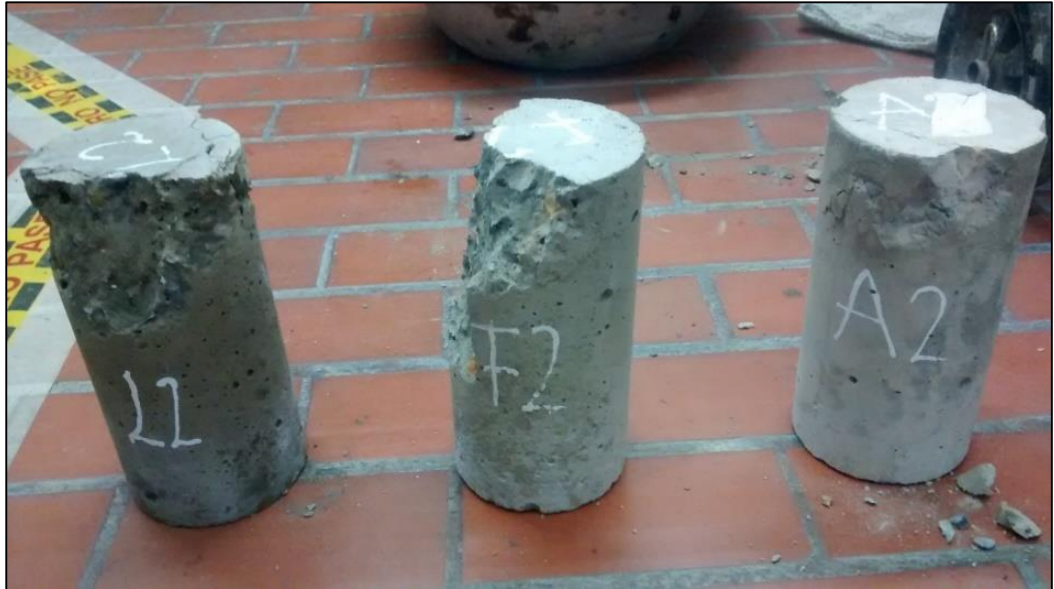
Ilustración 29 Falla a compresión de cilindros a los 14 días de curado
