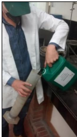
Ilustración 19 Dosis de aditivo Eucon 37 para la mezcla
