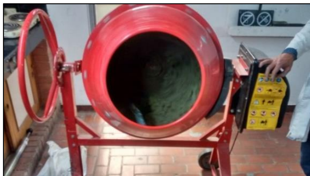
Ilustración 17 Mezcla de materiales para la fabricación del concreto
