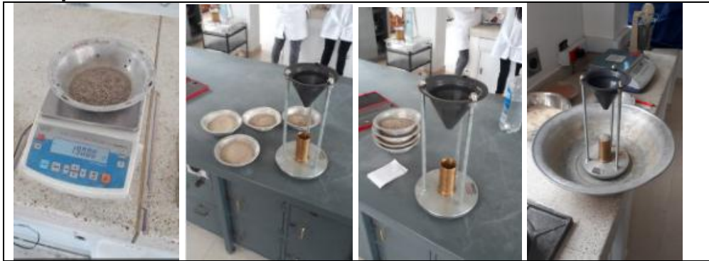
Figura 11. Preparación Ensayo Contenido de vacíos en agregados finos no compactados INVE-239.
