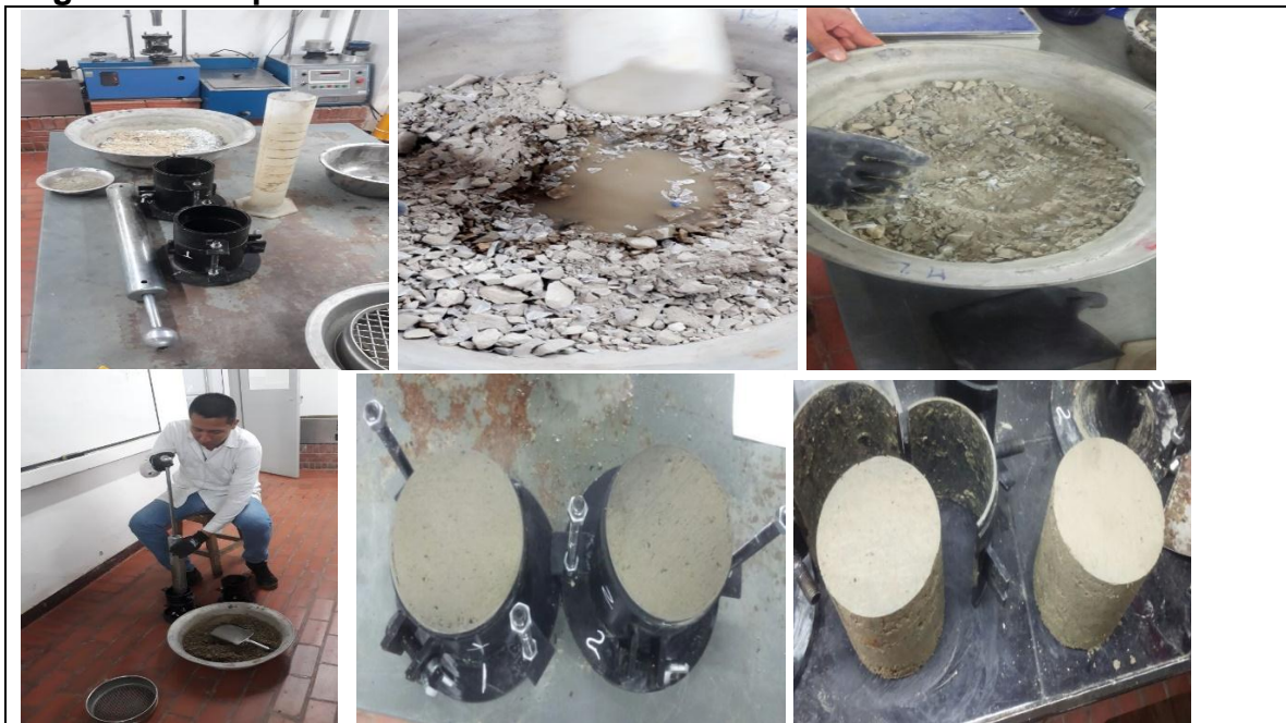
Figura 21. Preparación de los Cilindros
