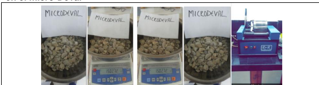
Figura 12. Ensayo de resistencia de agregados a la degradación por abrasión en el micro-Deval
