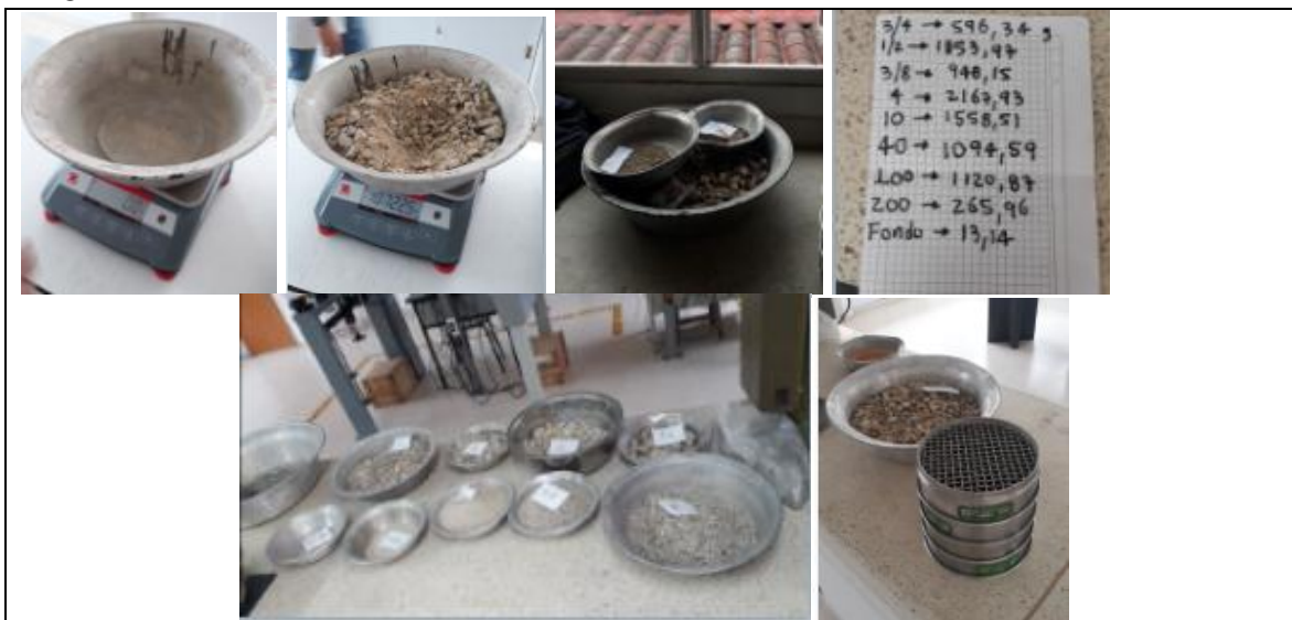
Figura 6. Análisis granulométrico de los agregados grueso y fino I.N.V. E – 213
