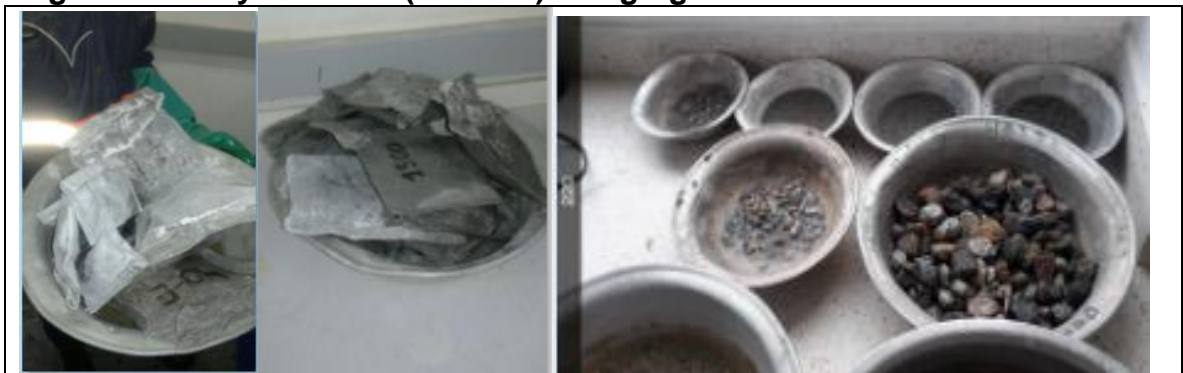
Figura 15. Esayo Solidez (sanidad) de agregados INV E-220
