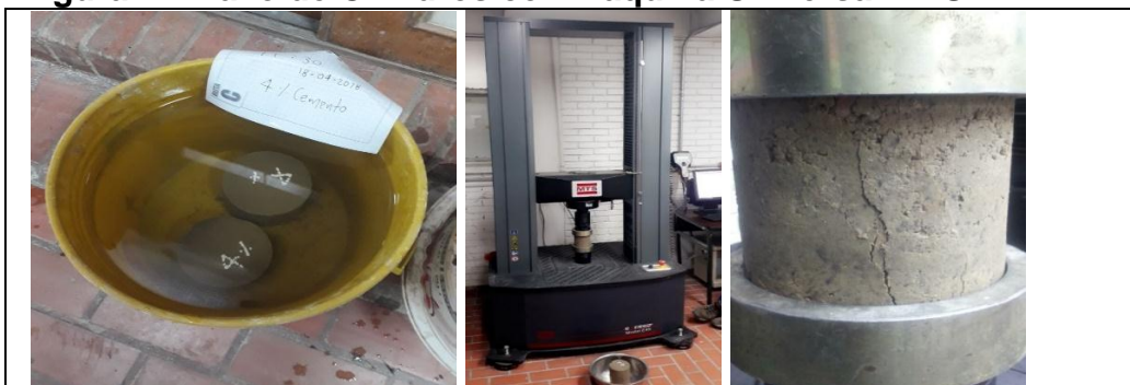
Figura 22. Fallo de Cilindros con Máquina Universal MTS
