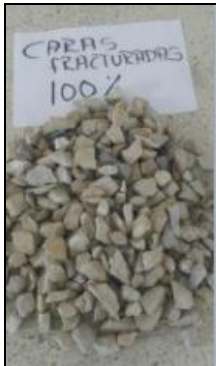
Figura 19. Ensayo Porcentaje de caras fracturadas en los agregados INVIAS E -227
