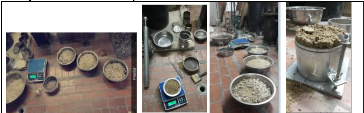
Figura 13. Relaciones de humedad - masa unitaria seca en los suelos ensayo modificado de compactación
