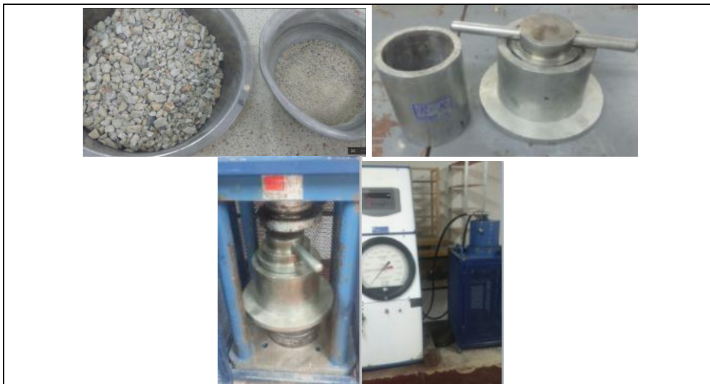
Figura 9. Ensayo Evaluación de la resistencia de la resistencia mecánica por el método del 10% de finos INVE-224
