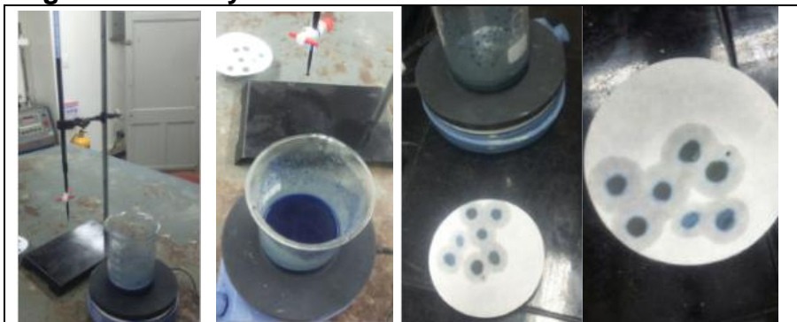
Figura 10. Ensayo Azul de metileno
