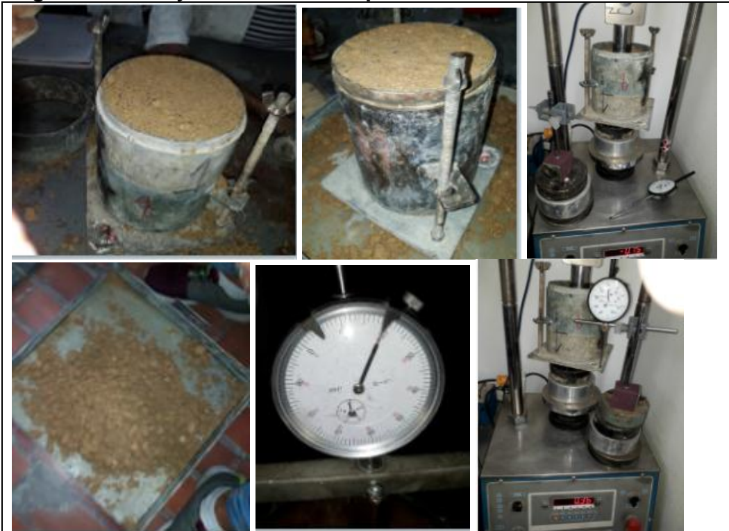
Figura 17. Ensayo Relación de soporte del suelo en el laboratorio C.B.R
