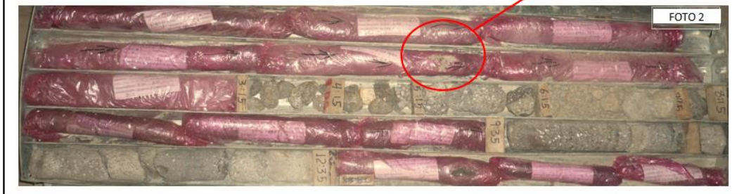
FOTO 1, 2, 3. MUESTRAS OBTENIDAS PERFORACION SONDEO No. 2 DESDE 0.00m HASTA 15.00m DE PROFUNDIDAD
