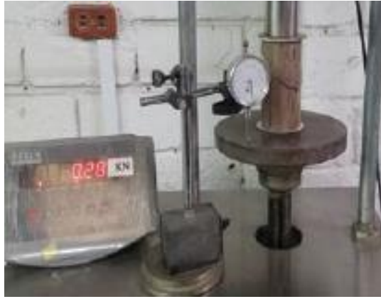
Ilustración 18. Proceso de falla para muestra de compresión inconfiada
