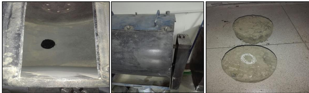
Figura 19 Maquina de los angeles y cuerpo de prueba convencional
