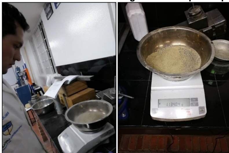
Figura 6 Dosificación de material granular cuerpos de prueba
