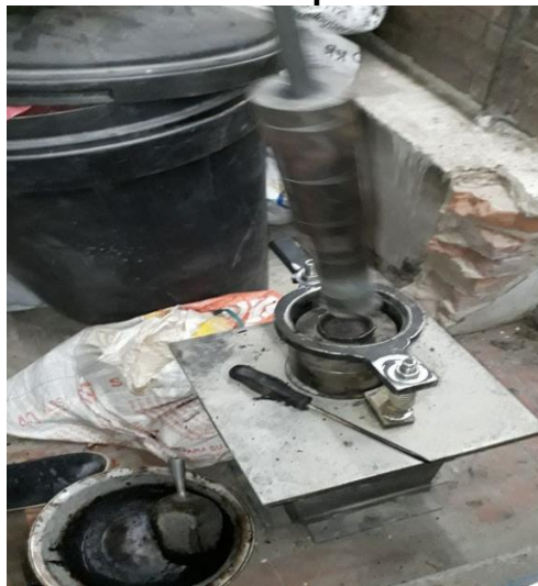
Figura 10 Proceso de compactación de probetas
