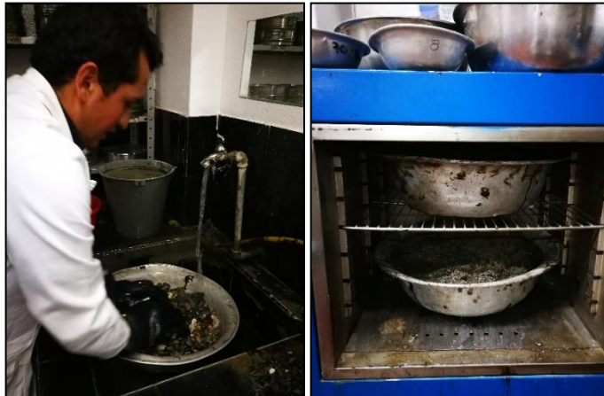
Figura 4 Lavado de material y secado de material granular
