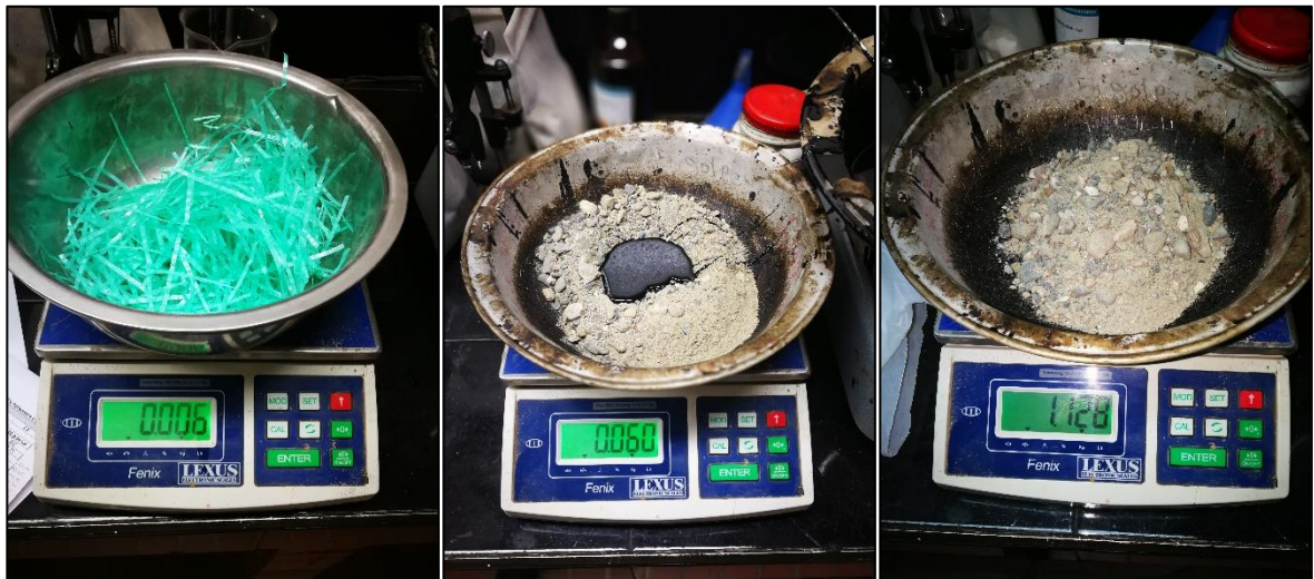
Figura 7 Dosificación material granular Probetas.
