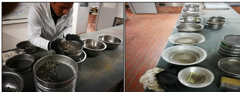
Figura 5 Tamizado de material granular
