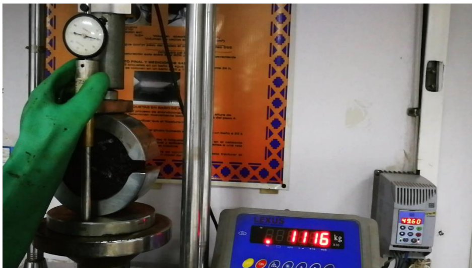
Figura 14 Falla de probetas y toma de lecturas
