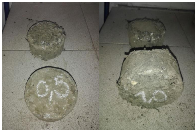
Figura 20 Cuerpo de prueba 0.5% y 1.0% posterior a ensayo de desgaste.
