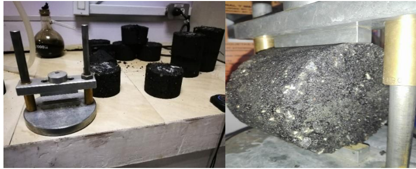
Figura 16 Prensa Lottman para carga TSR.
