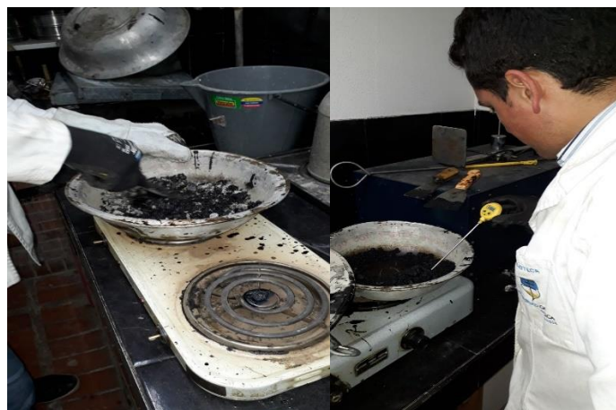
Figura 8 Mezcla agregado pétreo y Cemento Asfáltico
