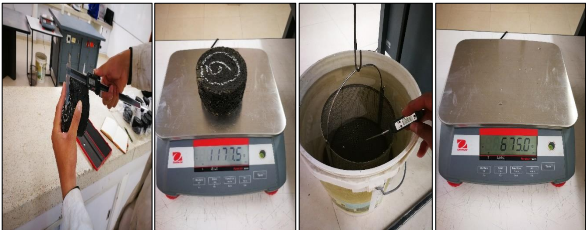
Figura 12 Toma de masa seca, sss, sumergida y altura de cuerpos de prueba
