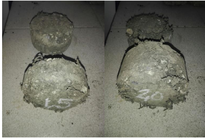
Figura 21 Cuerpo de prueba 1.5% y 2.0% posterior a ensayo de desgaste.
