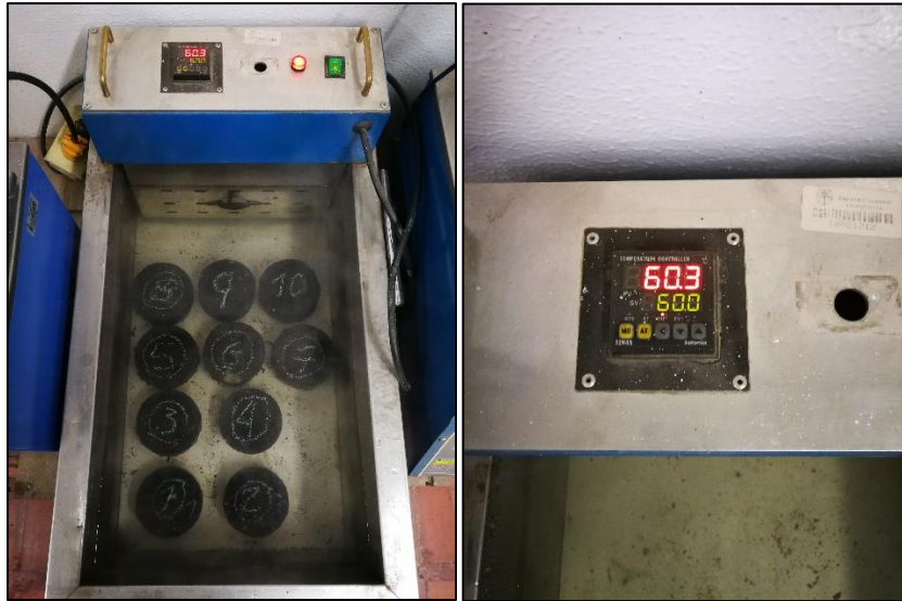
Figura 13 Baño de agua probetas previo al ensayo
