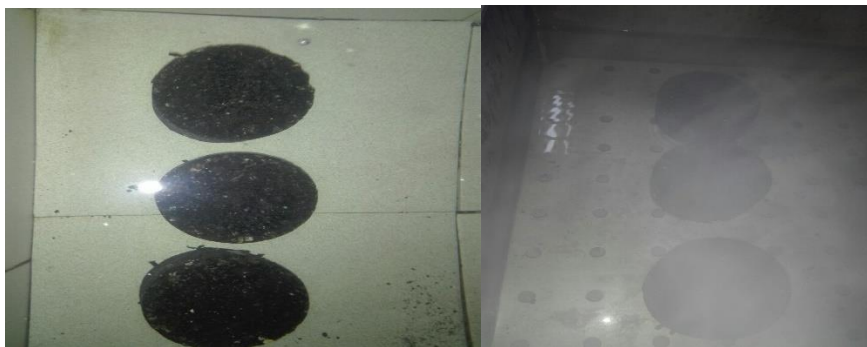
Figura 15 Acondición de probetas saturadas y secas para carga.
