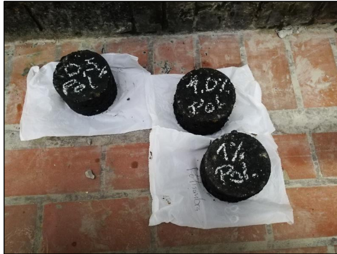
Figura 11 Clasificación probetas asfalto modificado
