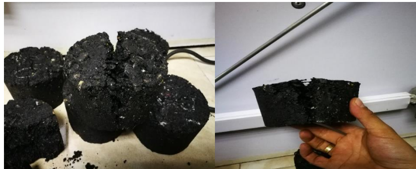
Figura 17 Falla de probetas TSR
