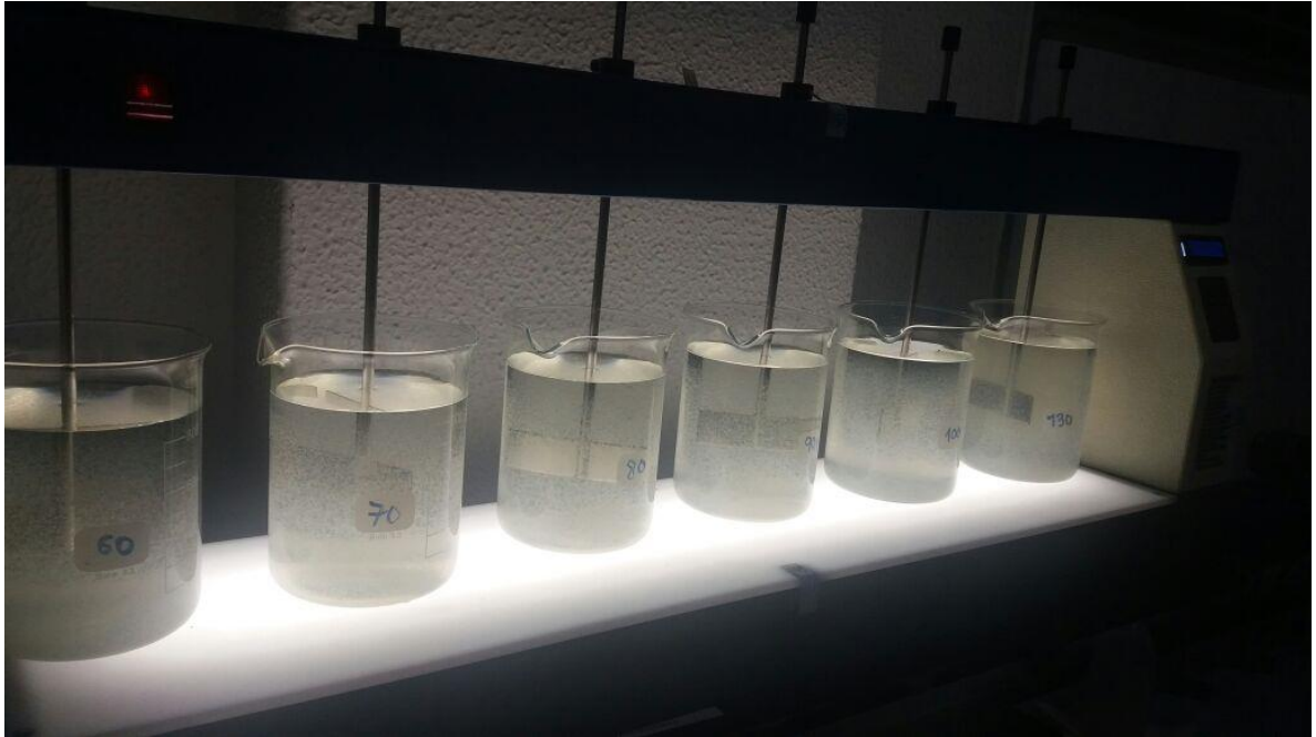
Anexo 25. Formación de floc en muestras de agua cruda analizadas. Universidad Católica de Colombia.
