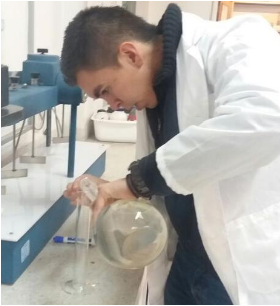
Anexo 22. Adición de coagulante a cada una de las muestras con su cantidad en ml correspondiente.
