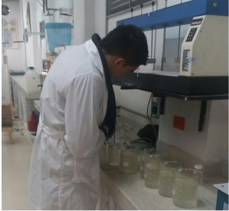
Anexo 22. Adición de coagulante a cada una de las muestras con su cantidad en ml correspondiente.
