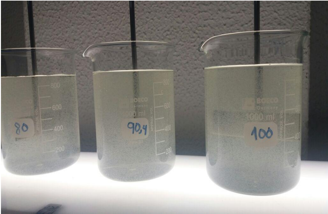
Anexo 24. Formación de floc en cada una de las muestras. Universidad Católica de Colombia.
