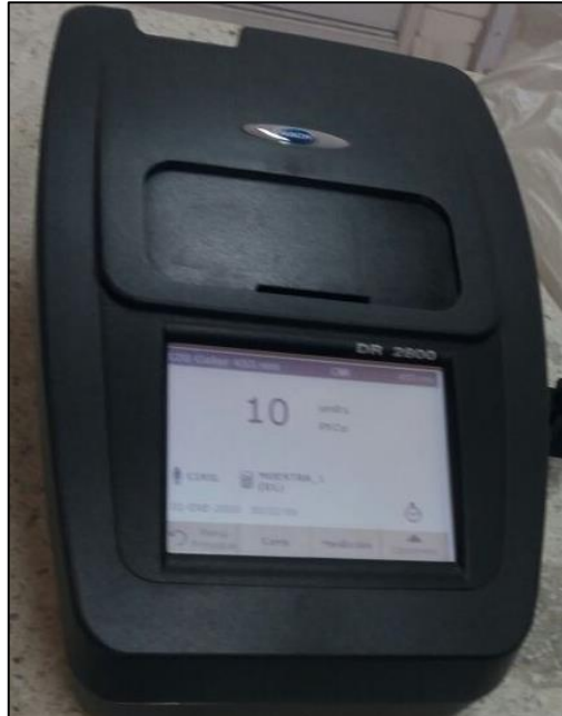
Anexo 11. Equipo utilizado para determinar cantidad de aluminio presente en muestra de agua tratada. Universidad Católica de Colombia.
