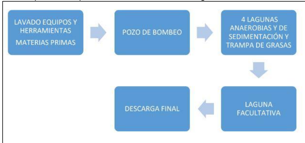
Figura 9. Esquema del proceso de tratamiento de agua residual.
